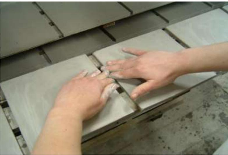
Une fois les carreaux cuits, les femmes s'occupent de la finition selon la demande des clients. Elles trempent les carreaux dans la teinte. La teinte est fabriquée grâce à « l'extrudeuse » (mélange de sable et d'un colorant).
